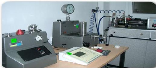
**8. Pression :** balance manométrique , tous types d'instruments de mesure de pression
